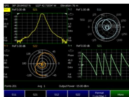
Одновременное измерение и отображение всех четырех S-параметров за одно подключение
