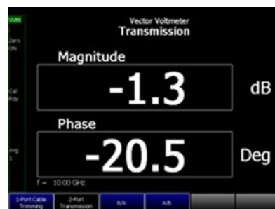
Балансировка кабелей с помощью векторного вольтметра
