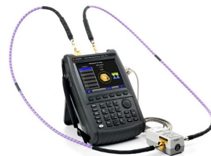
Быстрая и точная калибровка с помощью модуля ECal
