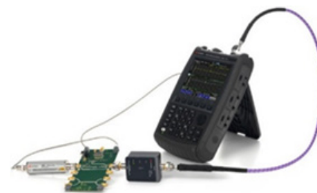
Точное определение коэффициента шума устройств
