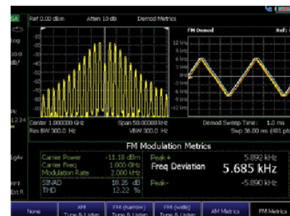
Определение характеристик сигналов с AM/ЧМ-модуляцией использованием аналоговой демодуляции
